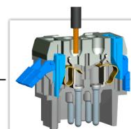
第三步：将已经剥去绝缘皮的导线插入到圆孔内；
