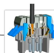
第四步：向内按压拨杆，会听到“啪”的一声，表示推杆已自动复位，弹片闭合，将导线和触头牢固连接；
