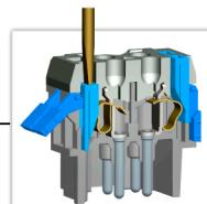
第二步：用3\*0.5一字螺丝刀，向下插入到方形推杆的凹槽内，顺势将其推至底部，同时拨杆会自动向外翘起，此时弹片稳定在开口状态线槽打开；
